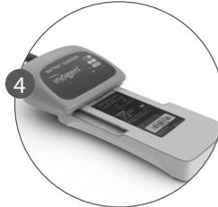
4. Conecte o carregador de bateria externo deslizando-o em direção à unidade de bateria até que ele se encaixe à bateria, fazendo um som de clique.
